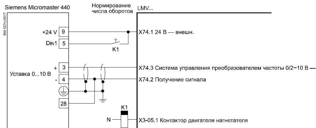
Рисунок 89: Подключение преобразователя частоты к LMV36
