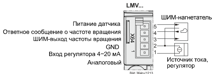
Рисунок 80: Внешний контроллер мощности через аналоговый вход X64 разъем 1/X64 разъем 2
